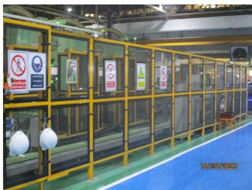
รูปที่ 5 การปิดล้อมเครื่องจักร
